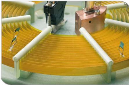
**Schutz gegen Kurzschluss:** Dieser zu einer Spule gewickelte Hochtemperatur-Supraleiter dient als Komponente eines Strombegrenzers, der Stromversorgungsnetze gegen Kurzschlüsse schützt.
