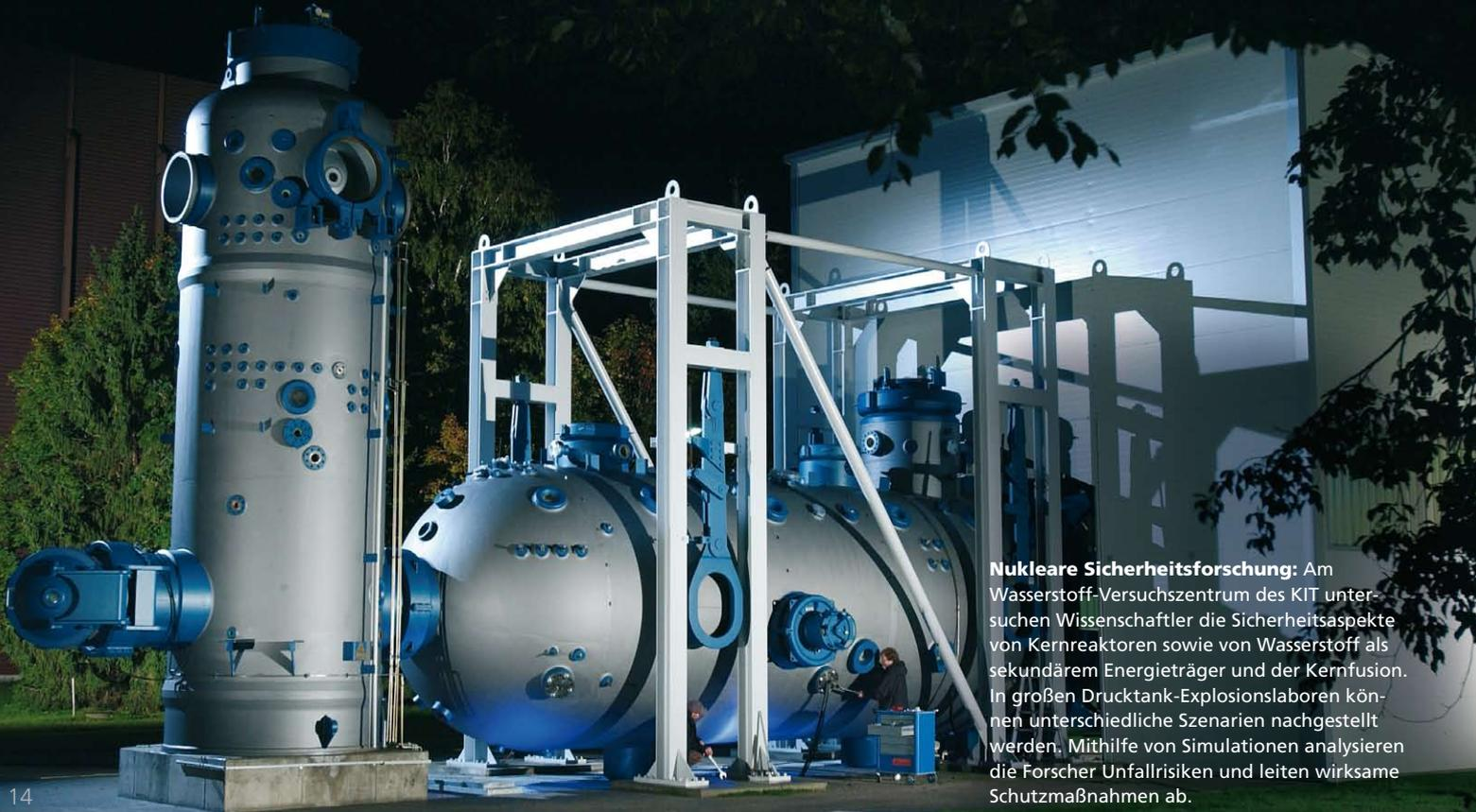
**Nukleare Sicherheitsforschung:** Am Wasserstoff-Versuchszentrum des KIT untersuchen Wissenschaftler die Sicherheitsaspekte von Kernreaktoren sowie von Wasserstoff als sekundärem Energieträger und der Kernfusion. In großen Drucktank-Explosionslaboren können unterschiedliche Szenarien nachgestellt werden. Mithilfe von Simulationen analysieren die Forscher Unfallrisiken und leiten wirksame Schutzmaßnahmen ab.
