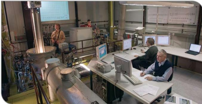
**Kühlexperimente:** Bei den Quench-Experimenten (Quenching – Abschrecken) in der KIT-Versuchsanlage geht es um das Einleiten von Wasser in den überhitzten Kern eines Leichtwasserreaktors – eine Schutzmaßnahme zur Temperaturabsenkung.
